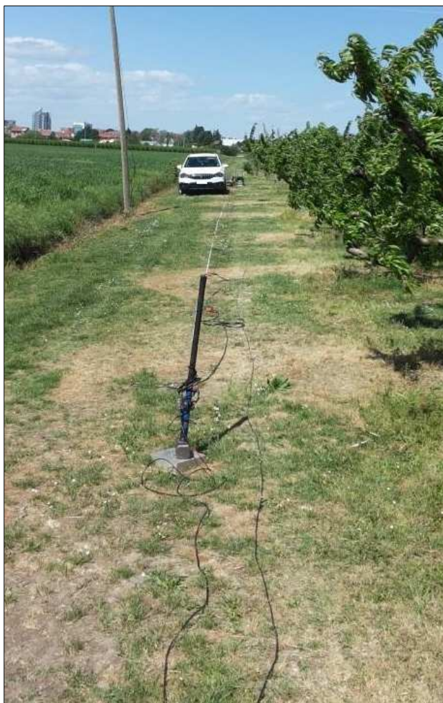
Figura 2 - Stendimento sismico MASW/Re.Mi.
