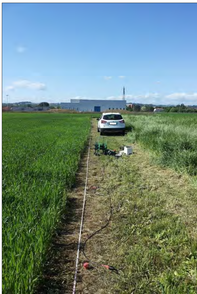
Figura 2 - Stendimento sismico MASW/Re.Mi.
