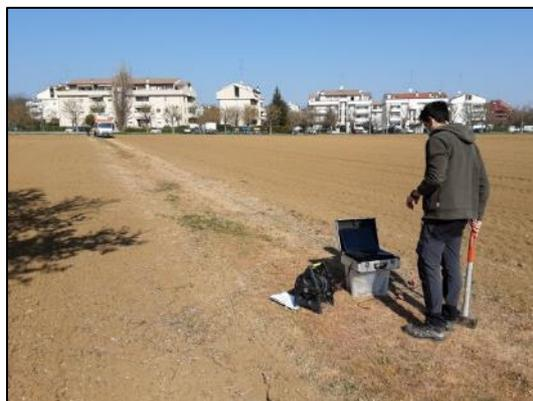
Figura 20. Indagine sismica con metodologia MASW.
