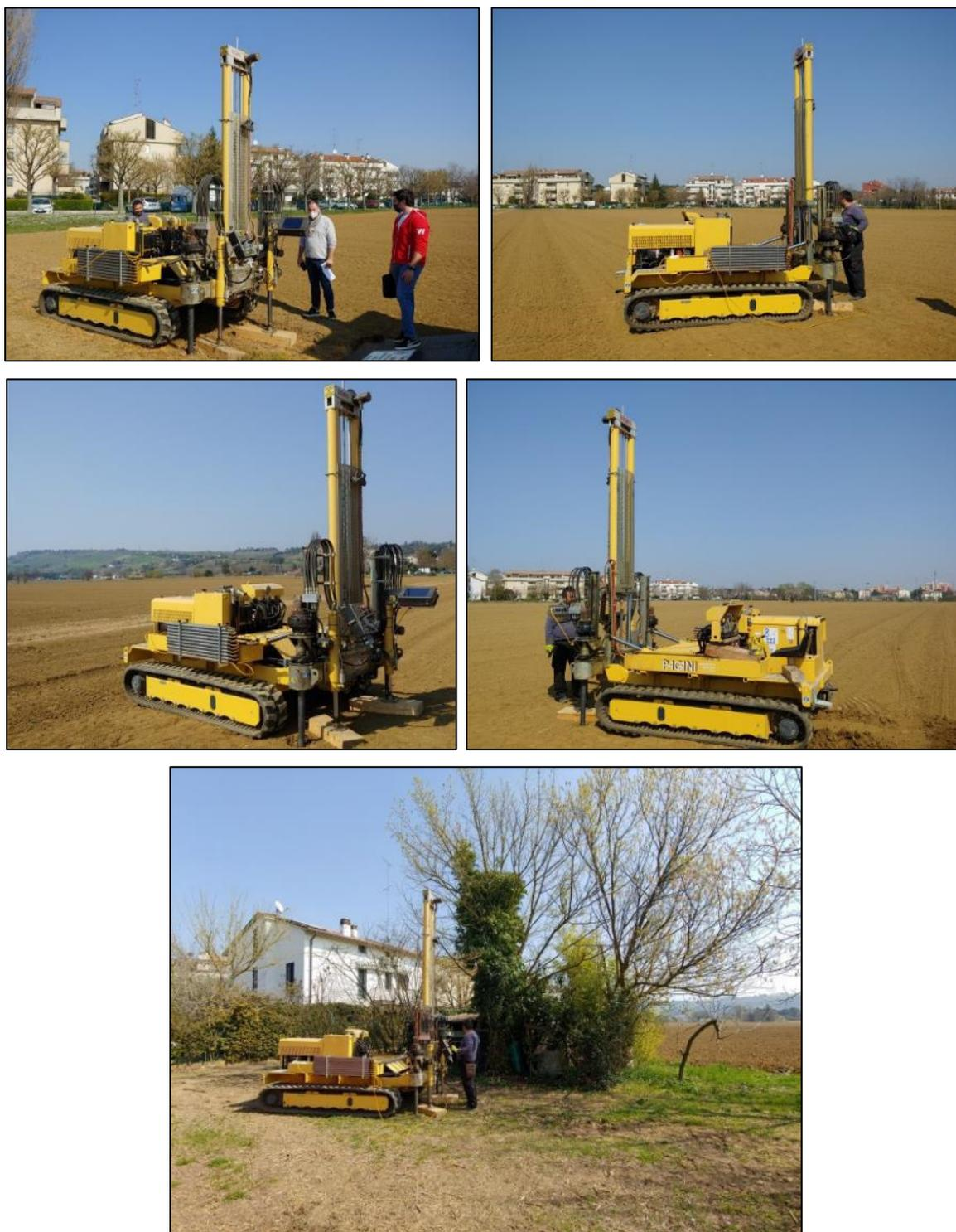
Figura 17. Esecuzione prove penetrometriche statiche CPTU.
