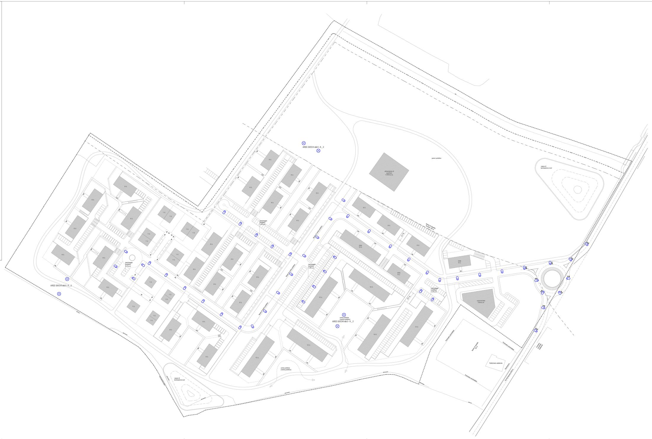
1) Punto luce con armatura stradale a LED, 4000°K, cl.2, IP66, fusibile di protezione, DIM-AUTO (riduzione del 30% per 6 ore dopo la mezzanotte virtuale), su palo conico diritto in acciaio zincato Hf.t.=9m, inclinazione 0°
