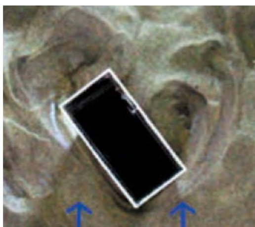
Figura 23: Esperimento di laboratorio, Dipartimento di Idraulica, Università di Pavia. Vista dall'alto di uno ostacolo rettangolare posto su letto sabbioso in seguito a simulazione.
